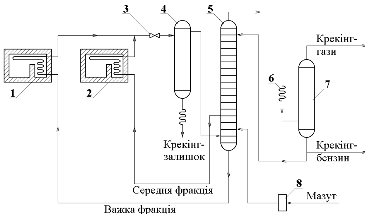
Рис. 2.1. Схема термічного крекінгу мазуту:
