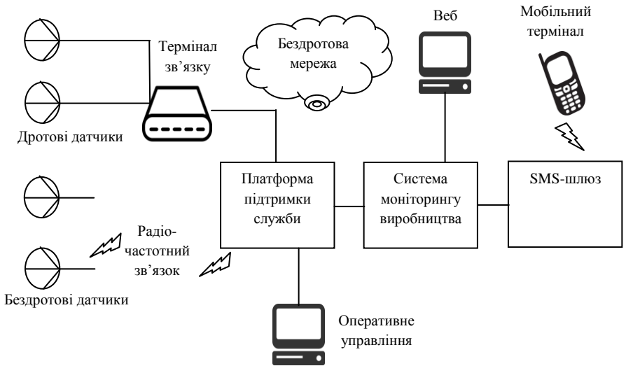
Рисунок 1 – Структура системи вимірювання показників оточуючого середовища та управління в овочівництві закритого ґрунту
