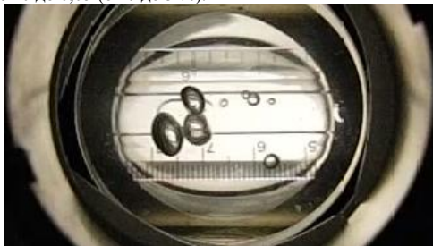
Рисунок 1 - Единичный видеокадр движущихся с потоком воды воздушных пузырьков
