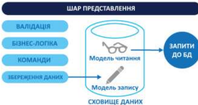
Рисунок 2 – Схема архітектури додатку з використанням CQRS для доступу до даних
