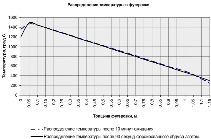
Рисунок 3 - Распределение температур по толщине футеровки конвертера в зависимости от условий охлаждения
