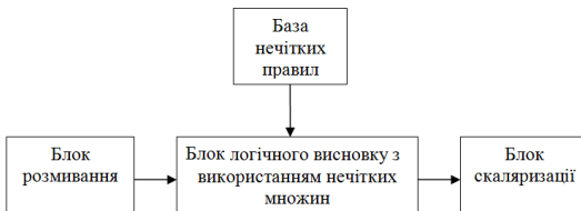
Рисунок 1 – Схема нечіткого пристрою керування
