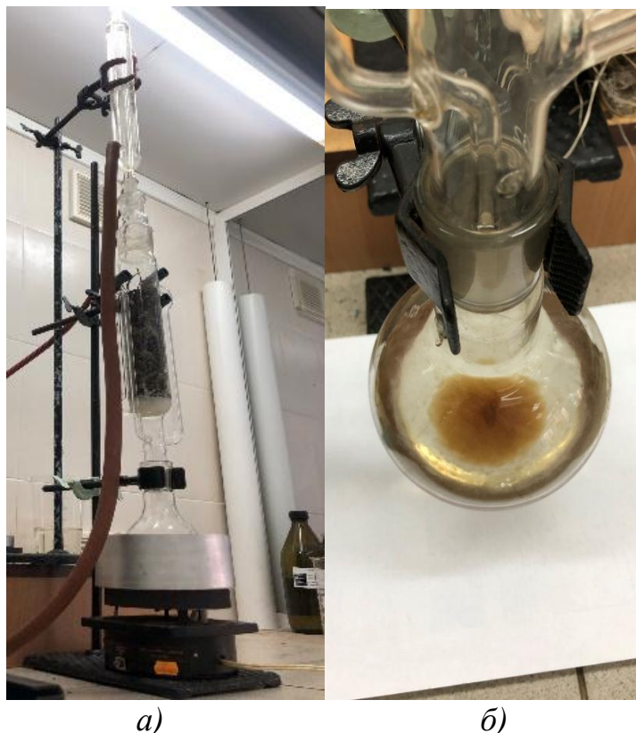
Рис. 2. Виділення ліпідної складової з водоростей: а) установка для проведення екстракції; б) зовнішній вигляд олійстої рідини виділеної з водоростей
