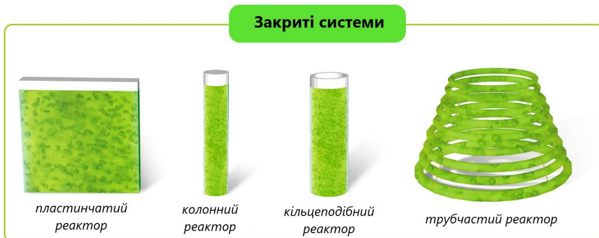
Рис. 1.2. Види закритих систем для культивування мікроводоростей
