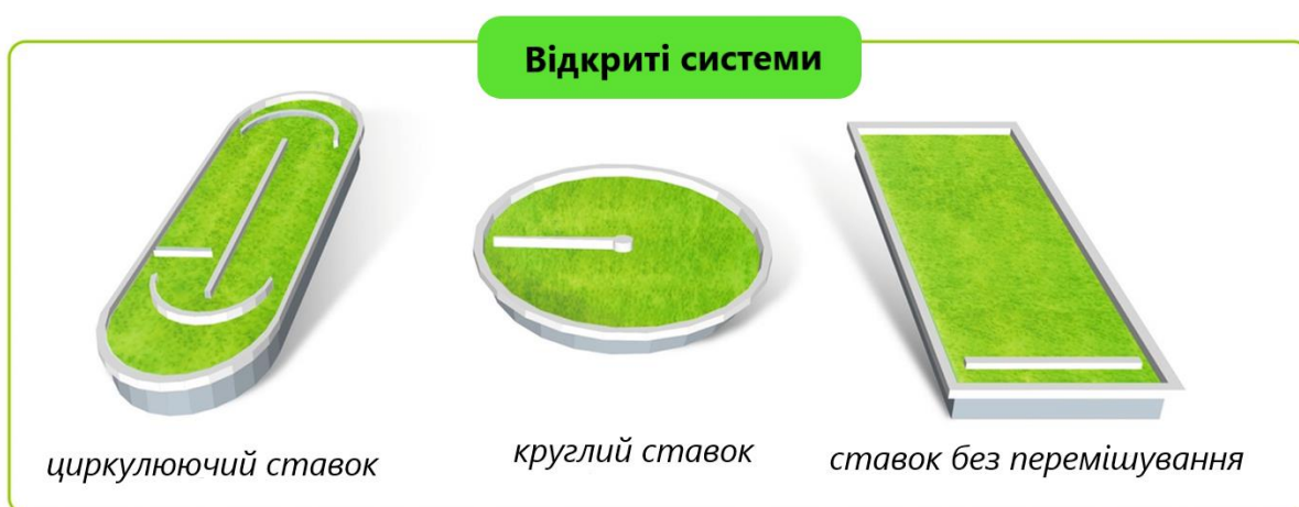
Рис. 1.1. Види відкритих систем для культивування мікроводоростей
