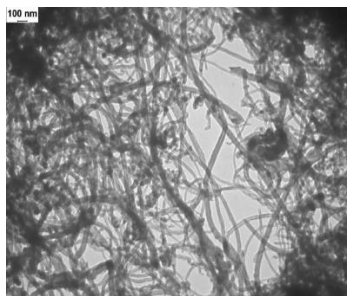
Рисунок 3.2 – Електронна фотографія нановуглецевих волокон, 100 нм.
