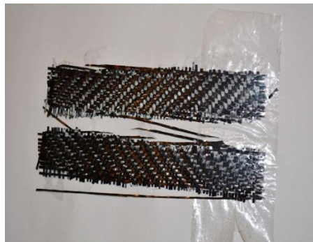
Рисунок 3.4 – Виготовлення зразків із заданими дефектами відшарування.
