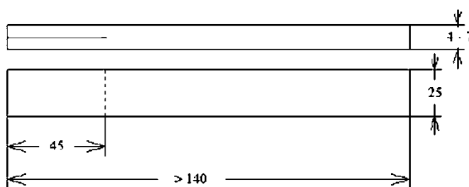
Рисунок 2.1 – Ескіз зразка в формі двухконсольної балки.
