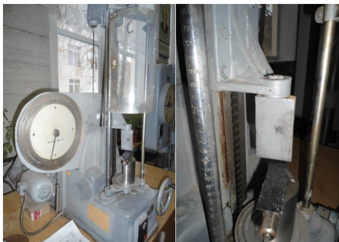
Рисунок 2.2 – Випробувальна машина МИП-100 зі зразком з ПКМ при випробуванні на тріщиностійкість.
