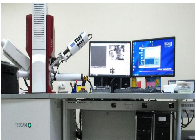
Рисунок 2.5 – Скануючий електронний мікроскоп з високою роздільною здатністю TESCAN MIRA 3 LMU
