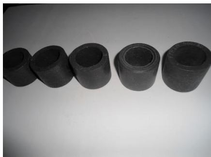
Рисунок 3.3 – Отримані зразки з ПКМ наповненого ЗВ ТЕЦ.
