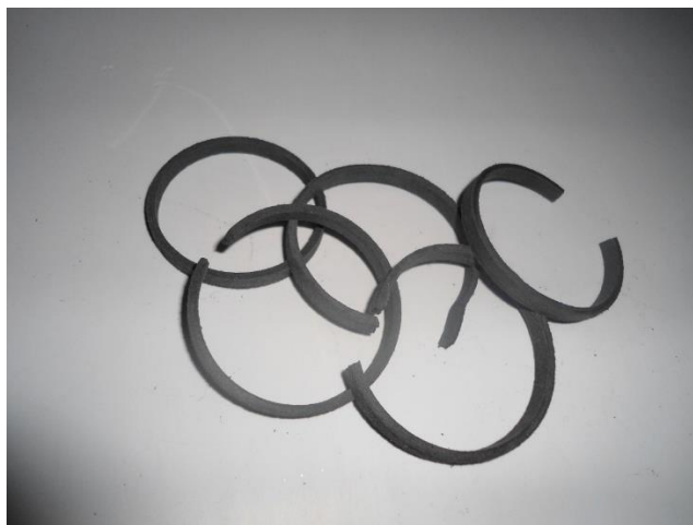
Рисунок 3.4 – Зразки з ПКМ до та після випробувань на розтяг.
