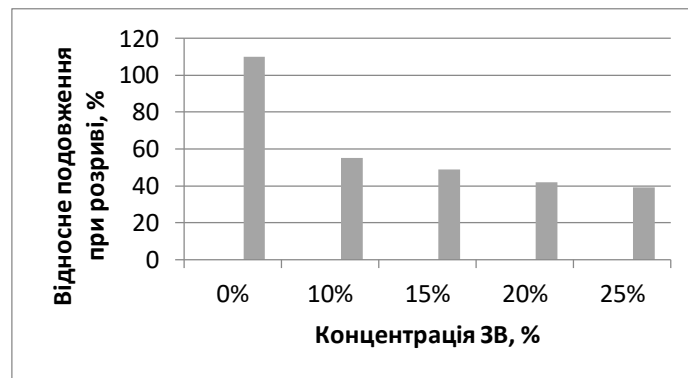
Рисунок 3.6 – Залежність відносного подовження при розриві від концентрації наповнювача.
