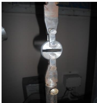
Рисунок 2.3 – Пристосування для випробувань зразків на розтягнення.
