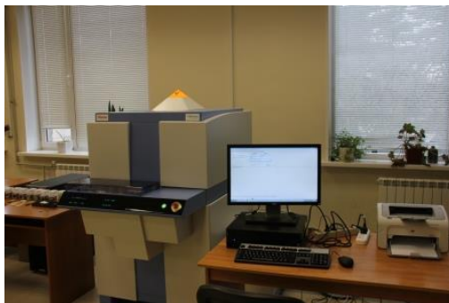
Рисунок 2.6 – Рентгенофлуоресцентний спектрометр серії ARL 9900 WorkStation з вбудованою системою дифракції.
