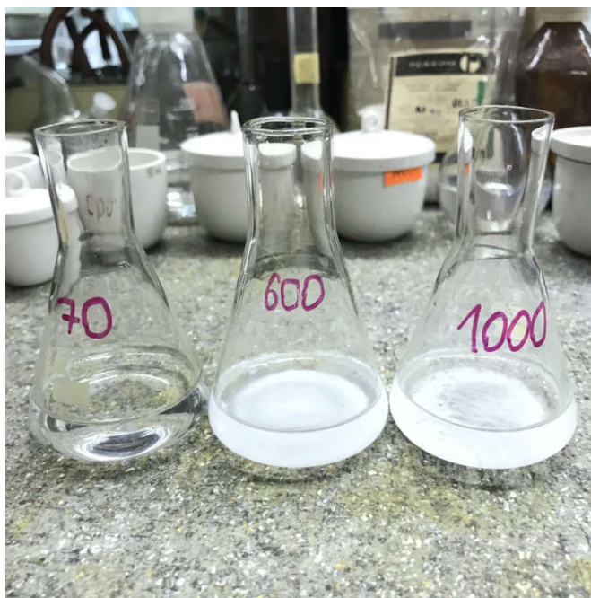
Рис. 3.6. Дослідження розчинності фосфату кальцію-магнію, прожареного при різних температурах.
