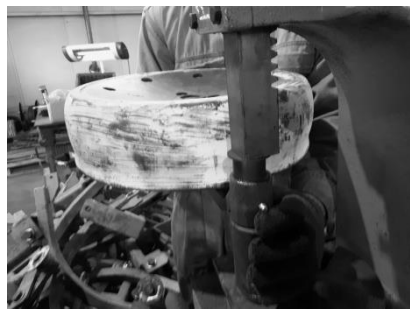
Рисунок 8.7 – Технологія збирання лап посівного комплексу «JohnDeere 1780»: а – запресування втулки з ПКМ; б – монтаж важелів на посівну лапу; в – посівна лапа у зборі
