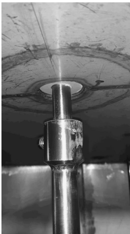
Рисунок 8.4 - Деталь з ПКМ на основі фторопласту-4 та силікагелю вузла тертя та герметизації консольного вала механічної мішалки
