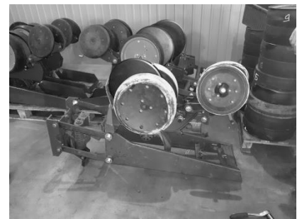
Рисунок 8.7 – Технологія збирання лап посівного комплексу «JohnDeere 1780»: а – запресування втулки з ПКМ; б – монтаж важелів на посівну лапу; в – посівна лапа у зборі
