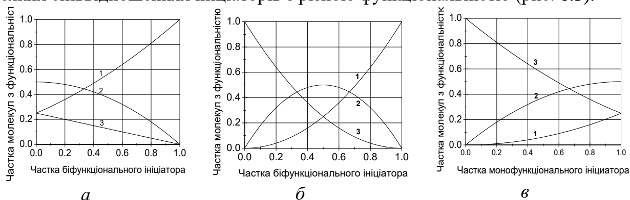
Рис. 6.9. Номограма для визначення частки молекул олігомерів з різною функціональністю при ініціюванні полімеризації сумішами ініціаторів:
