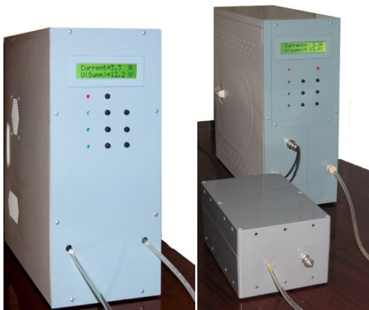
Рис. 19. Лабораторні прототипи електрохімічних пристроїв синтезу розчинів гіпохлориту натрію
