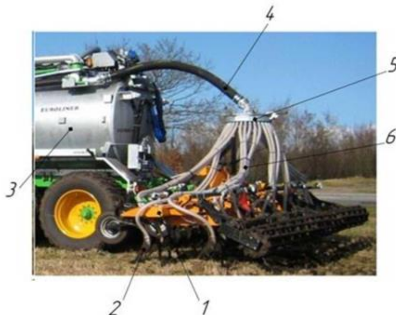
Рисунок 5.12 – Агрегат SN 800 для внутрішнього внесення рідких добрив
