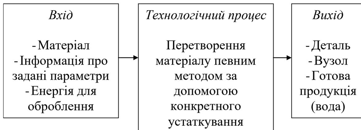
Рис. 2.9 Схема технологічного процесу як системи
