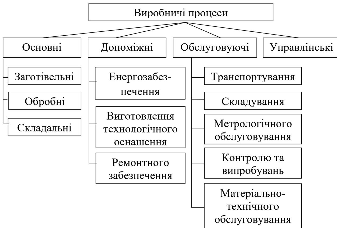
Рис. 2.10 Структура виробничих процесів
