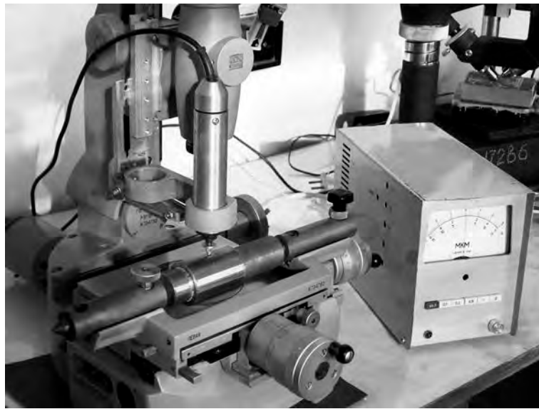
Рис. 4.5. Вимірювач малих переміщень 214-II-15
