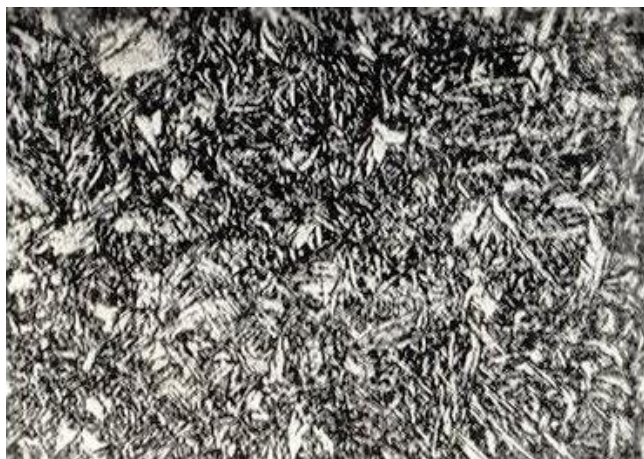
Рисунок 2.5 Мартенситна структура загартованого сплаву VT3-1, x300
