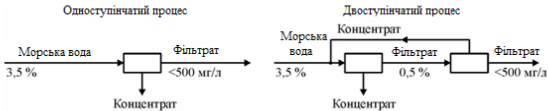
Рис. 4.3. Схеми одно- і двоступеневих зворотноосмотичних установок
