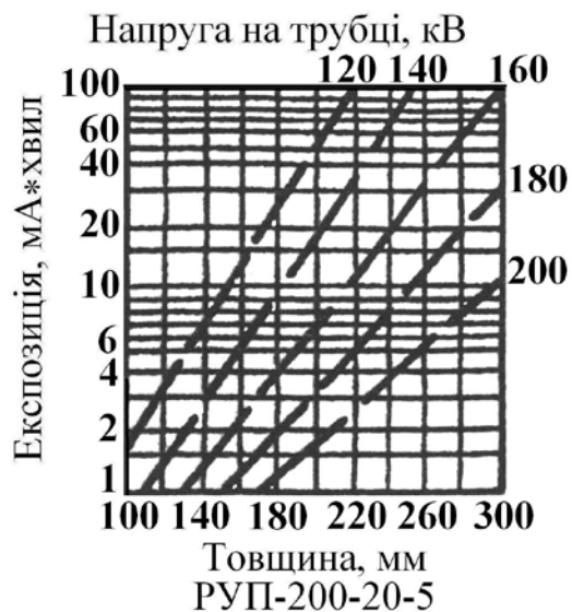
Рис. Б.4 Номограми експозиції просвічування деталей з магнієвих сплавів рентгенівськими апаратами на плівку РТ-1 (F = 75 см)
