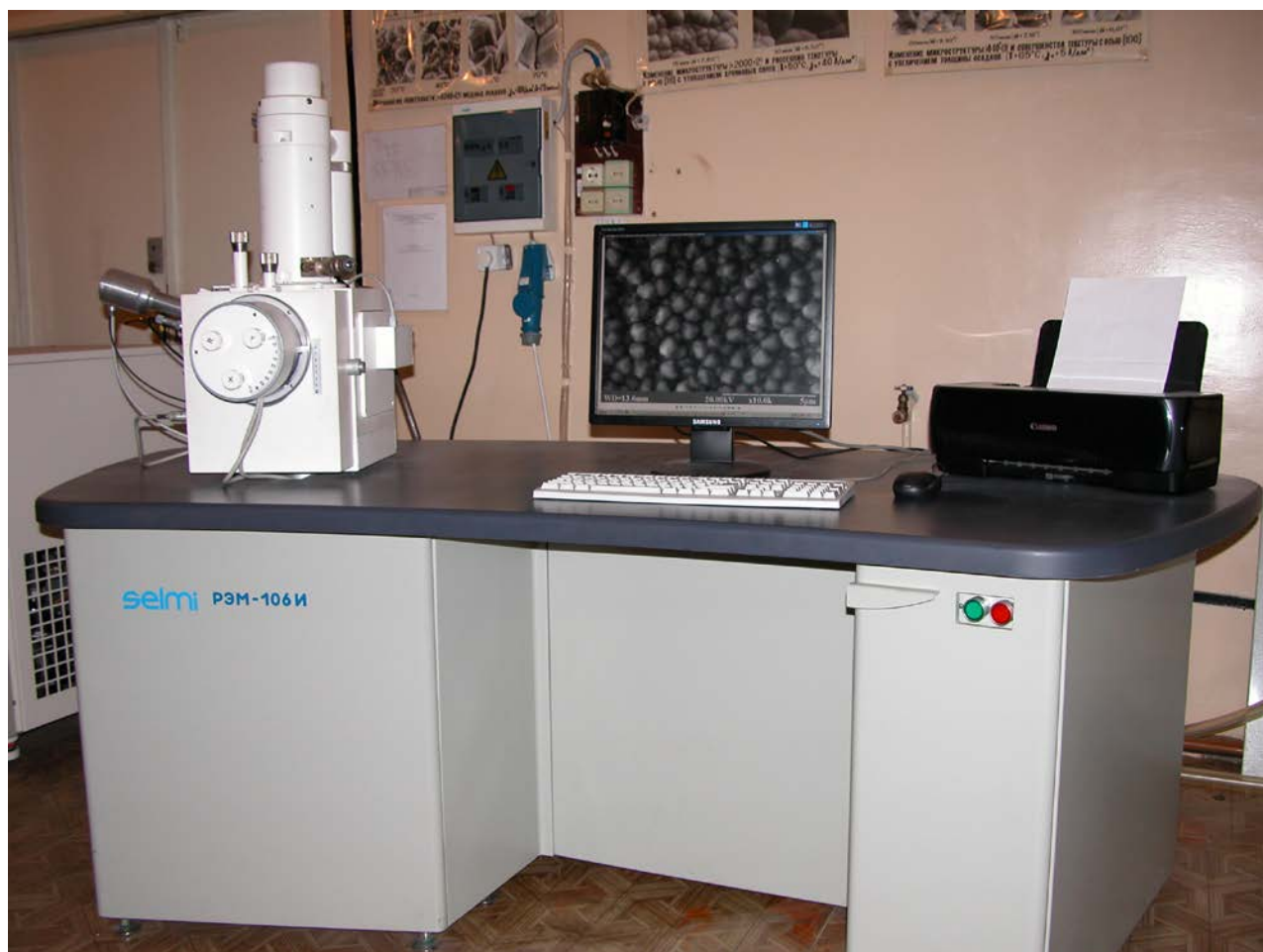
Рисунок 2.1 Зовнішній вигляд растрового електронного мікроскопа РЭМ-106И (лабораторія електронно-мікроскопічного аналізу кафедри матеріалознавства Українського державного хіміко-технологічного університету)
