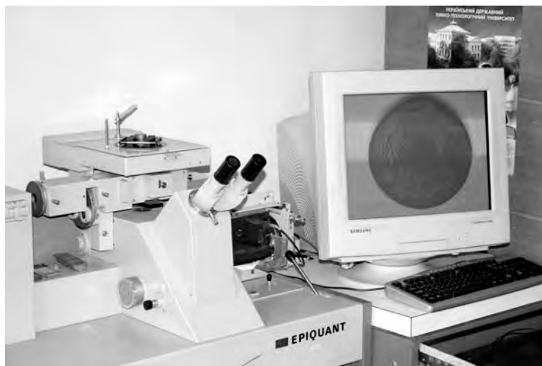
Рис. 6. Мікроскоп EPIQUANT з приставкою цифрової реєстрації зображення мікроструктури
