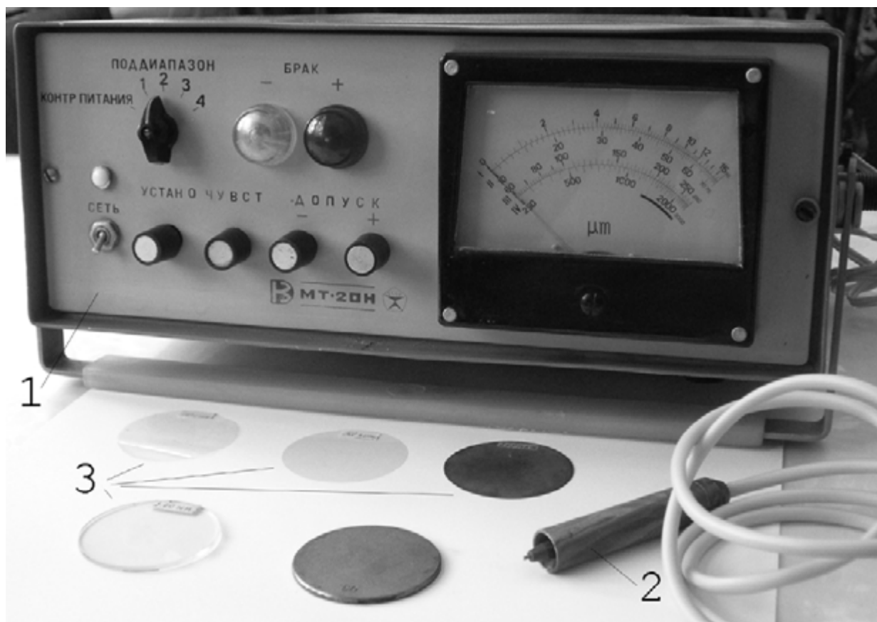
Рис. 6.1 Прилад МТ-20Н для вимірювання товщини немагнітних покриттів: 1 – електронний блок, 2 – перетворювач; 3 – набір еталонів товщини покриттів
