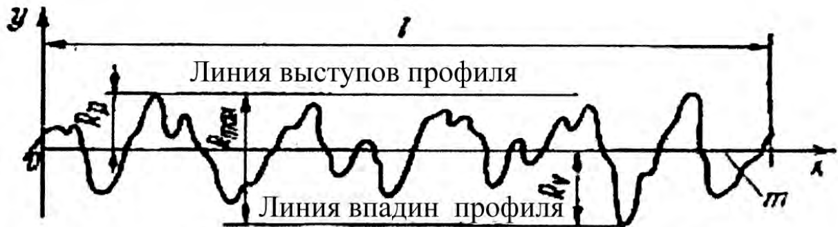
Рис. 3.1 Схема визначення найбільшої висоти нерівностей профілю R_{\max}
