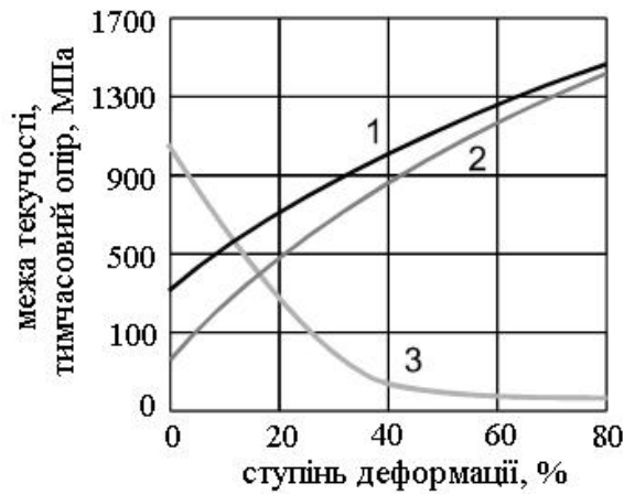
Рис. 1.4. Вплив ступеня холодної деформації на характеристики механічних властивостей сталі 08кп:
