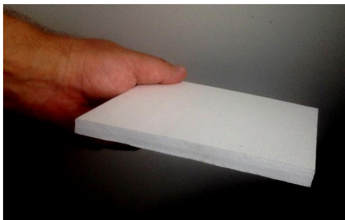
Зовнішній вигляд прототипу негорючого теплозахисного покриття товщиною 11 мм, розробленого на кафедрі ХТВМС
