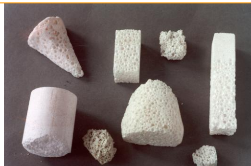
пориста кераміка для заповнення порожнин трубчастих кісток- Al_2O_3 ; Zr_{0,95}Y_{0,05}O_2 ; Ca_5(PO_4)_3OH
