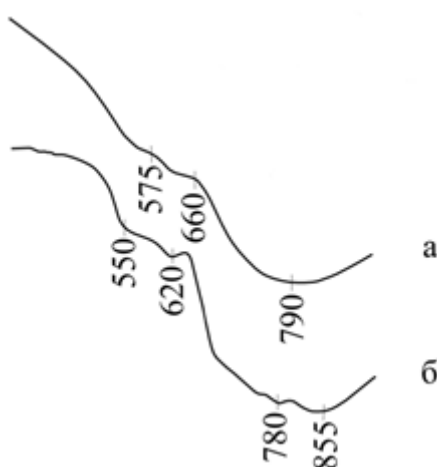
Рис. 3.18 – Диференційно-термічний аналіз дослідного скла: а – склад №10; б – склад №10 з 0,4 мол.% \text{Fe}_2\text{O}_3
