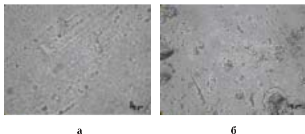
Рис. 3. Мікрофотографії композитів на основі олігоуретанакрилату і монтморилоніту, модифікованого ЦТАБ та ДМАЕМАХ (а) та ДМАЕМАХ (б) в масштабі 1 см – 100 мкм
