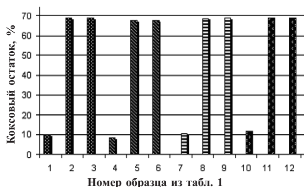
Рис. 2. КО под действием открытого пламени и от состава образцов: 1,4,7,10 – исходные материалы; 2,5,8,11 – обработка БАПЭ; 3,6,9,12 – обработка аддуктов ДА
