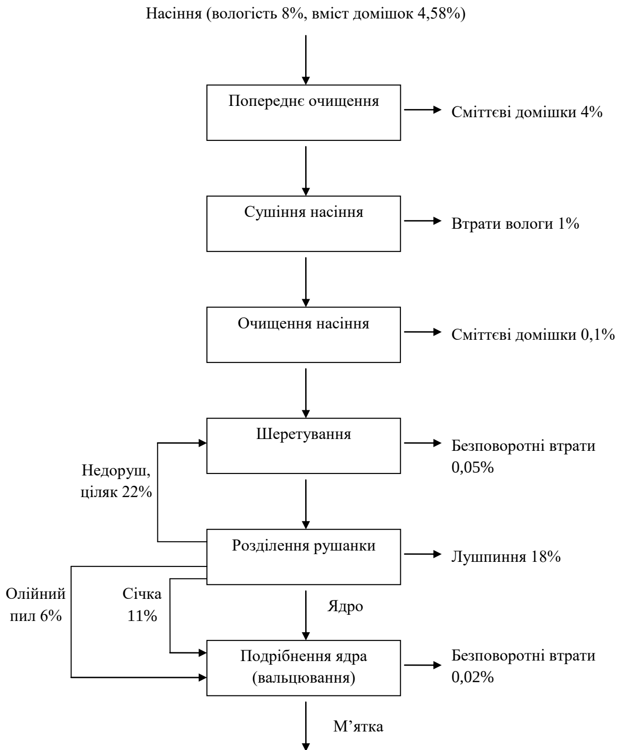
Рисунок 4.1 – Блок-схема процесу очищення насіння соняшника і підготовки ядра до пресування
