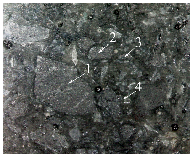
Рис. 1. Дисперсна структура ( \times 100 ) полідисперсного кремній карбїду в зносостійкому епоксидному композиті оптимального складу:
