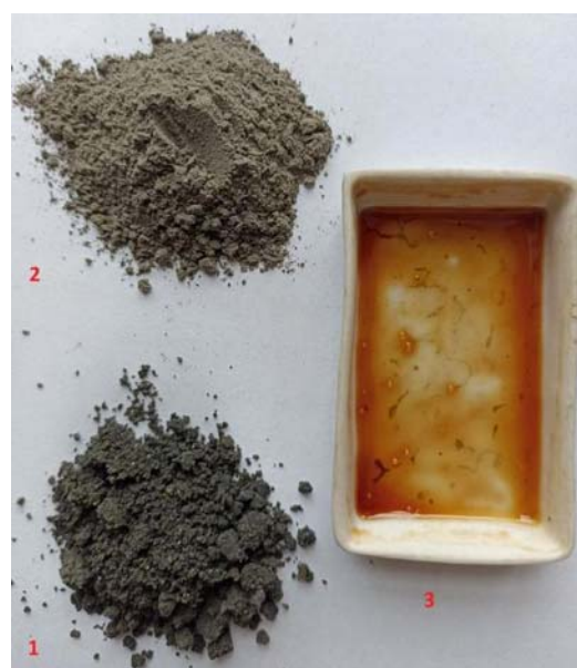
Рис. 1. Зразки відбільної глини до (1) і після (2) оброблення естеро-альдегідною фракцією та зразок адсорбату (3) після упарювання екстрагенту
