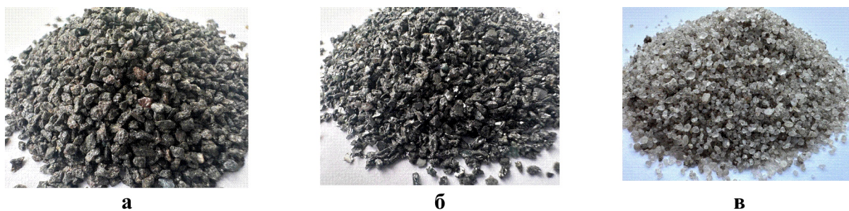
Рис. 4. Зовнішній вигляд частинок абразивів: а – електрокорунд нормальний; б – кремній карбїд; в – кварцевий пісок
