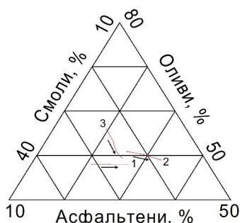
Рис. 1. Діаграма зміни групового складу бітумів в процесі старіння: 1 – окисненого БНД 60/90; 2 – залишкового БД 130/200; 3 – гудрону в процесі одержання окисненого бітуму
